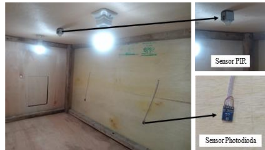
Gambar 6. Sensor PIR dan photodiode.
