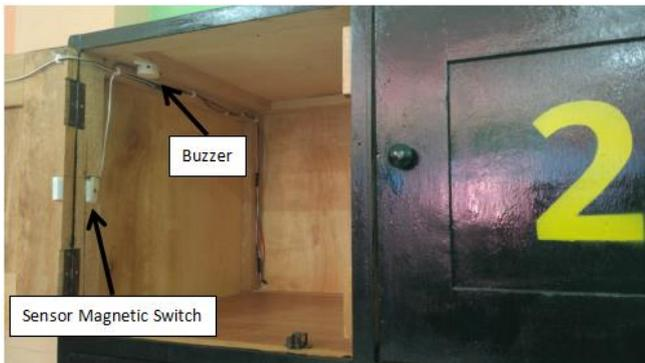
Gambar 3. Sistem notifikasi pada loker
