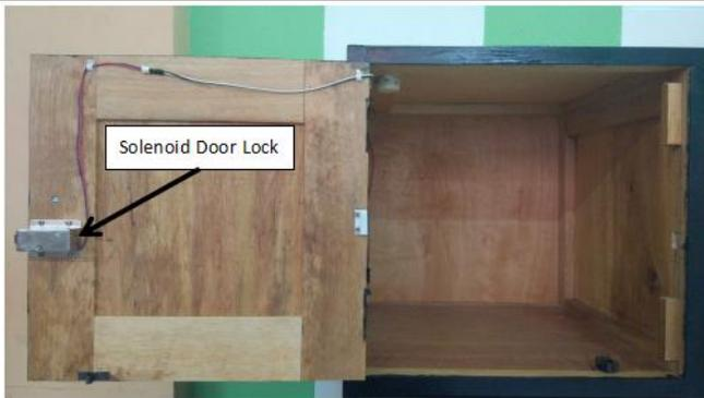
Gambar 2. Sistem penguncian pada loker
