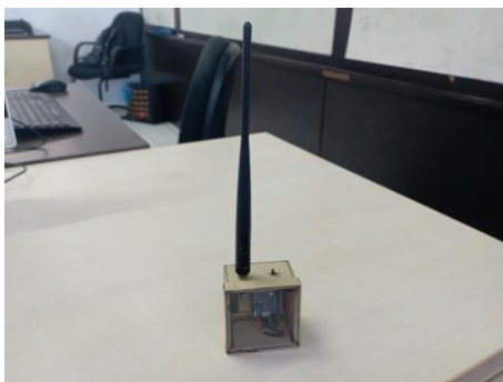
Gambar 4.3 Wi-Fi Repeater dengan Antena External
