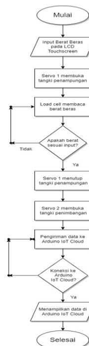
Gambar 2. Flowchart timbangan beras otomatis menggunakan Arduino IoT Cloud.
