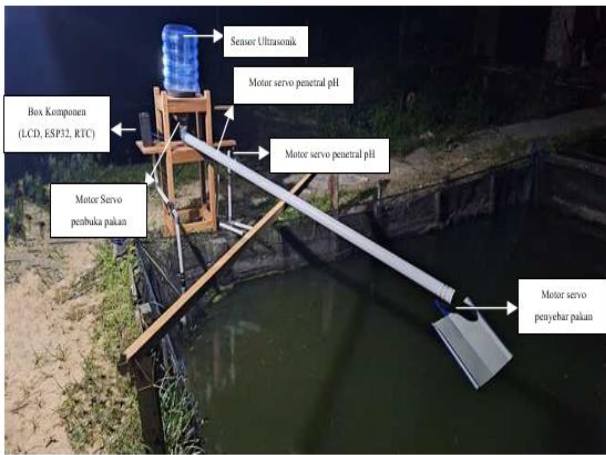
Gambar 6. Implementasi alat pada lokasi kolam lele
