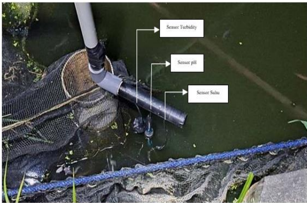
Gambar 7. Penempatan sensor pada alat
