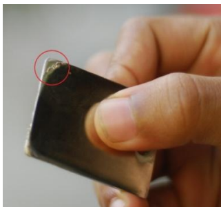
Gambar 2. Pelapisan dengan kuat arus 180 A
