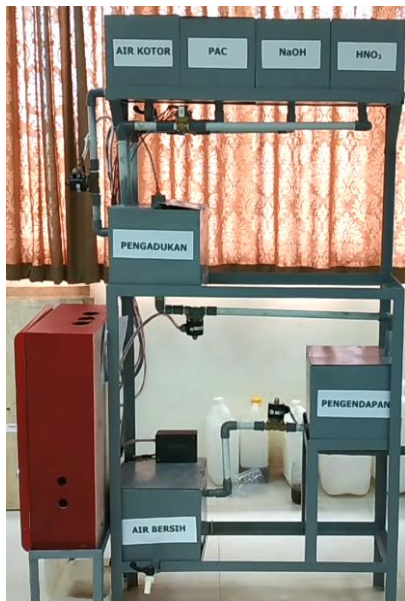
Gambar 15. Realisasi Sistem Kendali pH dan Kekeruhan Air
