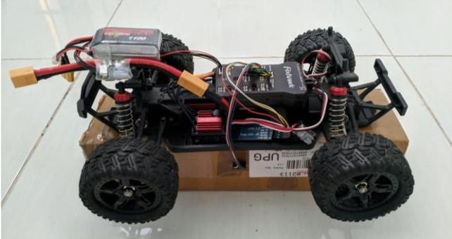
Gambar 1. Rover berpengerak motor *brushless*.
